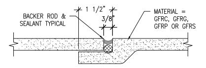
TYPICAL FLANGE DETAIL SCALE: 6"= 1'-0"
