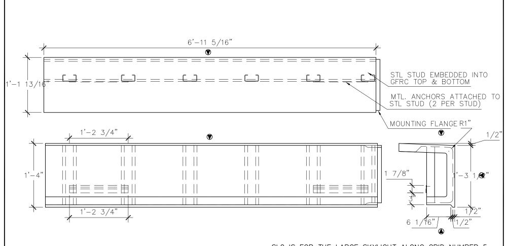
NOTE: STUDS SHOULD BE NO MORE THAN 2' O.C. REPRESENTS FINISHED SIDE OF PRODUCT SL2 IS FOR THE LARGE SKYLIGHT ALONG GRID NUMBER 5
